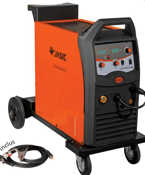
Le Jasic MIG 250 Compact est équipé de puissants composants IGBT, d'un affichage numérique A/V et de capacités multi-processus.
